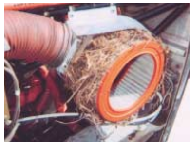
Un nid d'oiseau dans le filtre à air est difficilement identifiable
